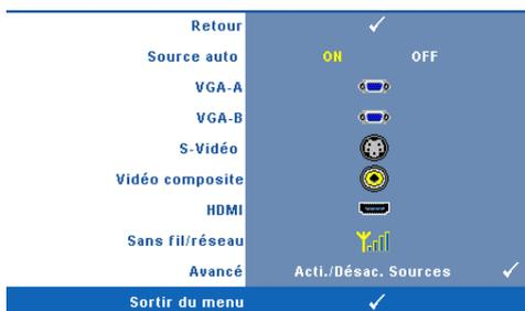
**SOURCE AUTO**—Sélectionnez **Off** (le réglage par défaut) pour verrouiller le signal d'entrée actuel. Si vous appuyez sur le bouton **Source** lorsque le mode **Auto Source** est réglé sur **Off**, vous pouvez sélectionner manuellement le signal d'entrée. Sélectionnez **On** pour détecter automatiquement les signaux d'entrée disponibles. Quand le
